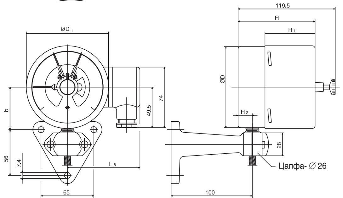
Зажим для измерительного прибора по DIN 16281
