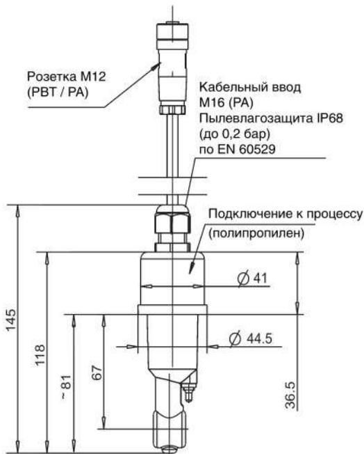
Отдельный сенсор для подключения –168 и 169 DN 32 и DN 40 (накидная гайка не входит в комплект поставки)
