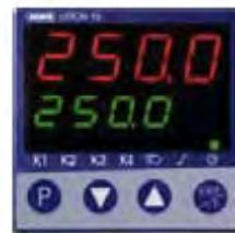
Для отображения действительных и заданных значений во всех конструкциях имеются, два 7-ми сегментных, жидкокристаллических дисплея с разными цветами отображения показаний (зелёный, красный). Дополнительно прибор содержит 7 светодиодов для отображения положения включения, ручного управления, линейно-нарастающей функции и режима таймера. Управление прибором осуществляется с помощью четырех кнопок на лицевой панели.
