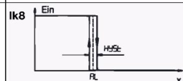
**Функция Ik8** аналогична функции Ik7, однако представляет собой инвертированную сигнальную функцию
