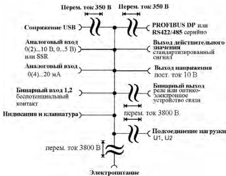
**Элементы индикации, обслуживания и подключения**
