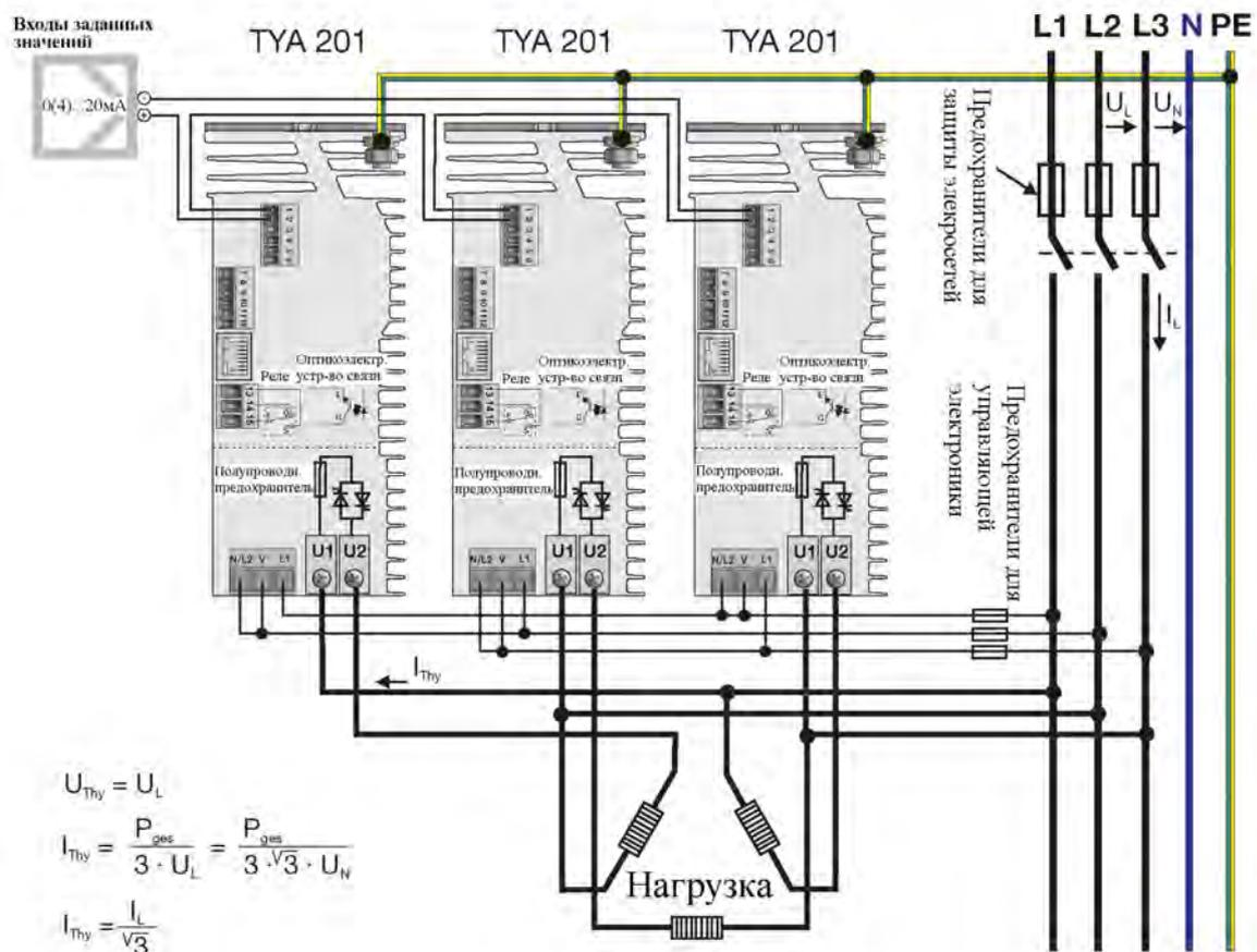
$U_L$  = напряжение между внешними проводами
