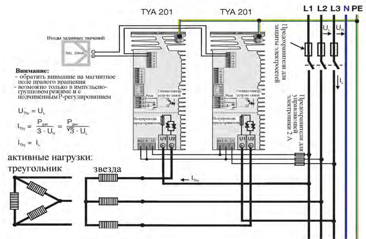
$U_L$  = напряжение между внешними проводами
